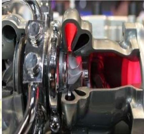
Gambar 2.7 *turbocharger tunggal*
