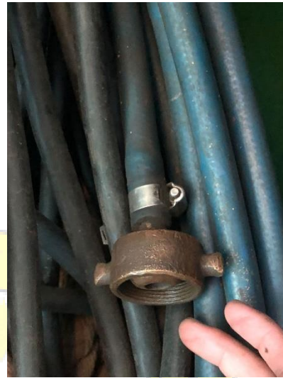
Gambar connector pneumatic pada valves pneumatic
