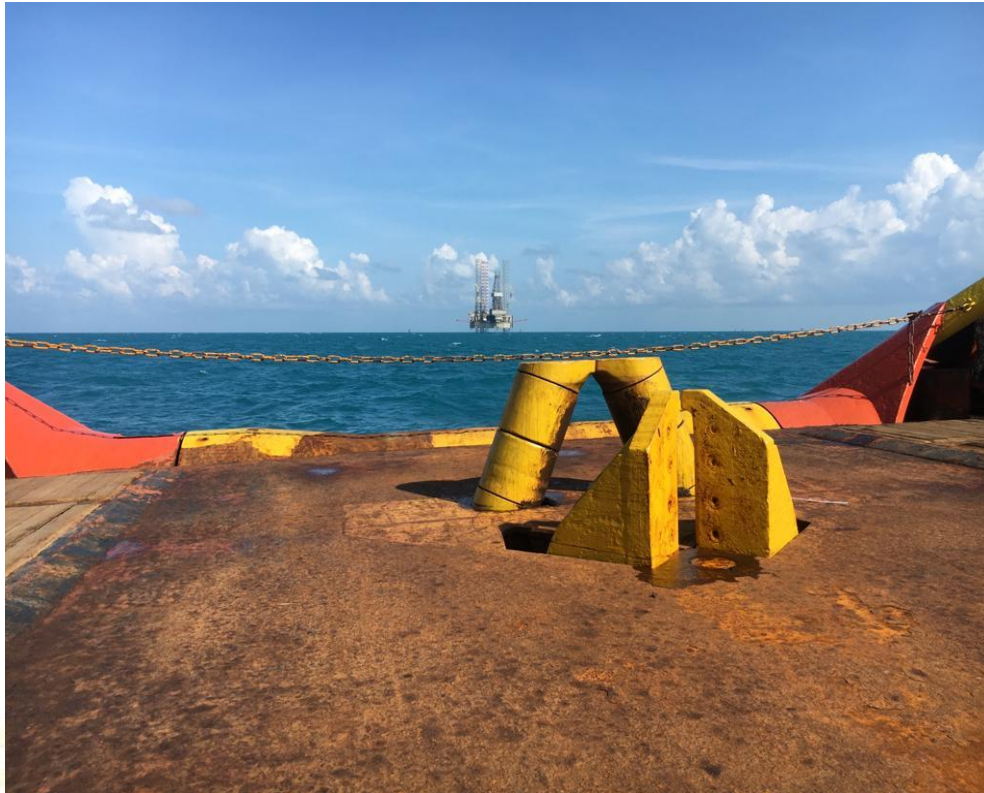
Gambar 4 : Pengujian towing pin dan shark jaw (Sumber : Dokumentasi Pribadi)
