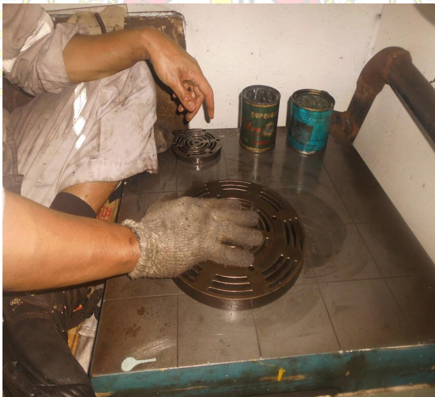
Gambar Kondisi First Stage Valve yang di Lapping
