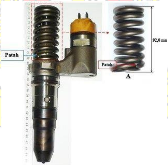
Spring Injector yang patah
