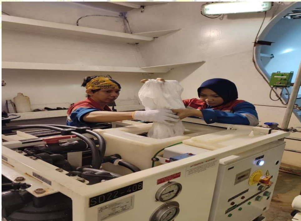
Gambar 9 : Penambahan Bahan Kimia Alkaline dan Acid
