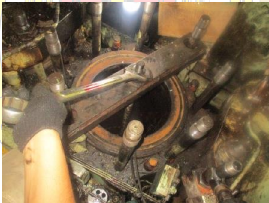
Gambar Pengukuran pada diameter Cylinder Liner
