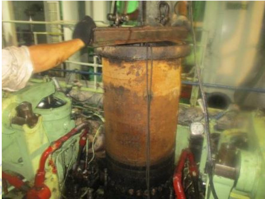
Gambar Proses Pencabutan Cylinder Liner yang rusak
