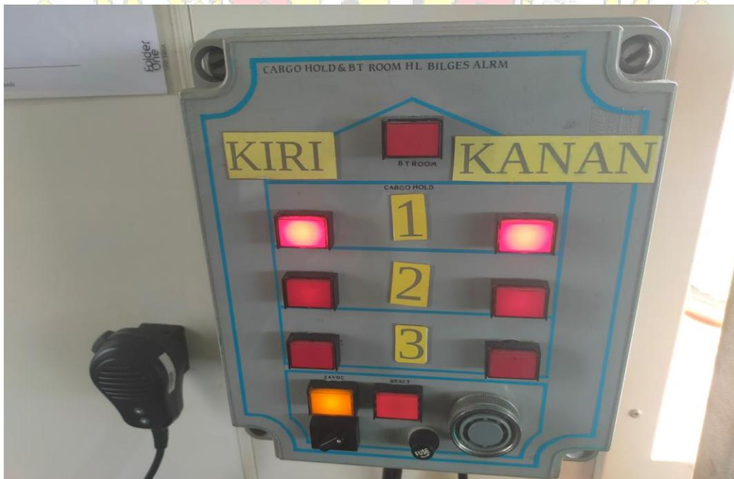
Pemantauan *test floating switch sensors* pada palka nomor 1
