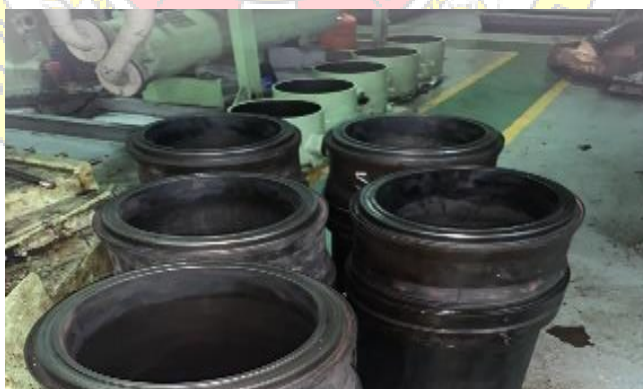
Gambar 2.6 Cylinder Liner di MT. PNS SERENA
