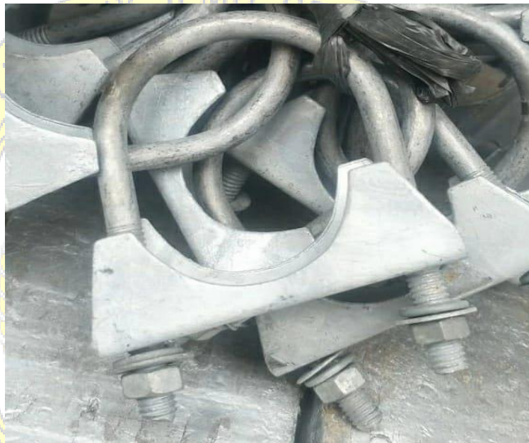
Gambar 2.5 Dudukan pipa Sumber : Dokumen pribadi
