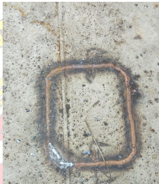
Gambar 4.7 Pengelasan sekat antara tangki Void 4 S dan tangki WBT 5 S
