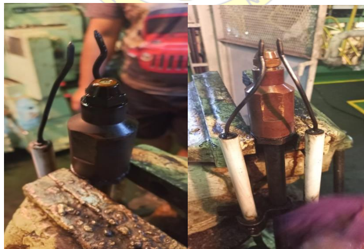
Gambar 4.1 sebelum dan sesudah perawatan dan perbaikan nozzel dan kawat elektroda
