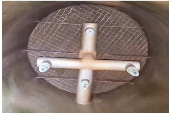
Gambar 2.3. Demister separator pada IGG MT. Prima XP
