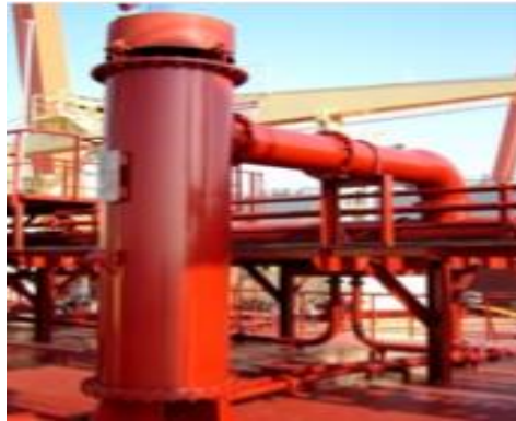
Gambar 2.7. P/V Breaker di MT. Prima XP
