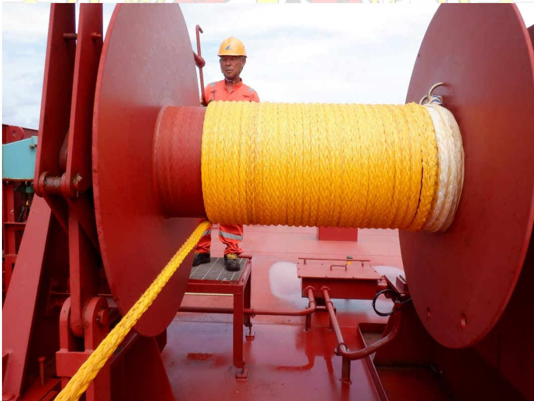
Gambar Pembenanahan Tali Mooring
