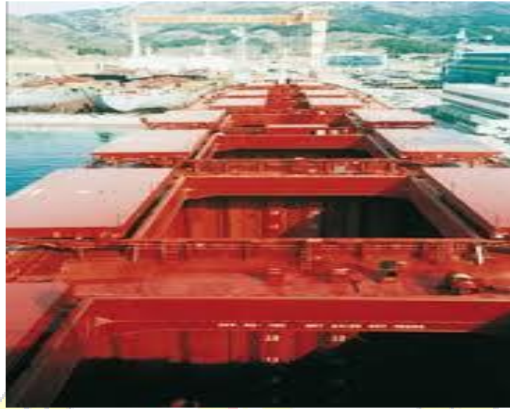
Gambar 2.3 Penutup Palka Jenis Rolling Stowing
