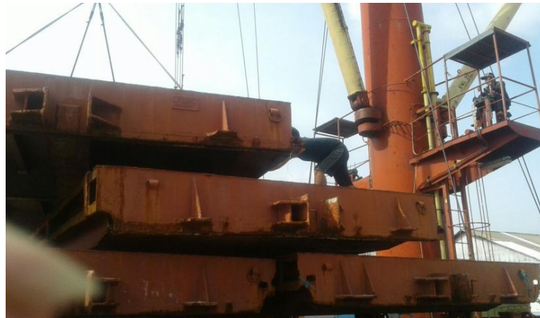
Gambar 2.2 Penutup palka jenis pontoon
