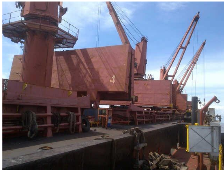
Gambar 2.4 Penutup palka jenis Rolling Side McGregor
