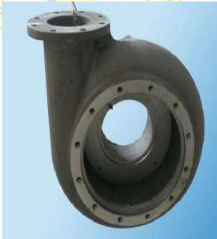
Volute dirancang untuk membentuk corong yang mengubah energi kinetic menjadi tekanan dengan mengurangi kecepatan dan meningkatkan tekanan.
