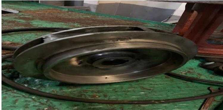
Gambar 2.3 *Impeller*
