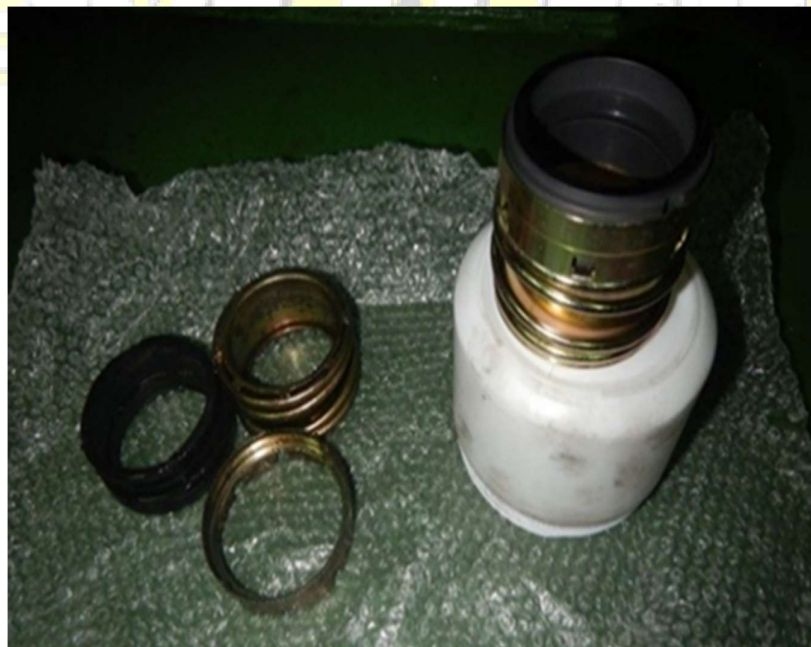
Lampiran 3. Rusaknya Mechanical Seal
