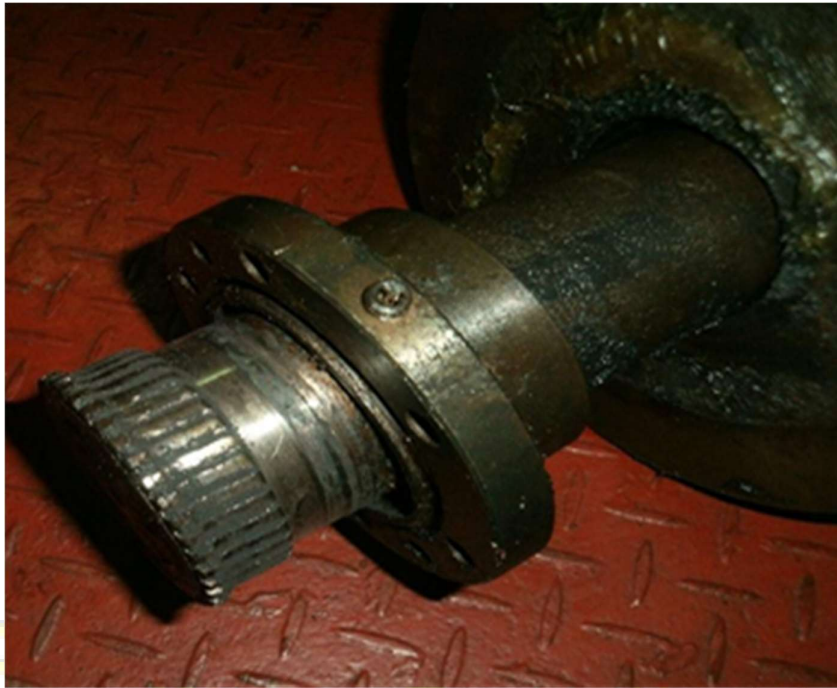
Lampiran 6. Rusaknya Shaft Bearing
