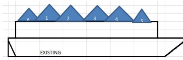
Gambar 4: Diagram urutan pemuatan menggunakan existing line (CV 15A & CV 15B)
