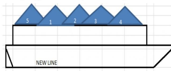
Gambar 3: Diagram urutan pemuatan menggunakan new line (CV 23A & CV 23B)
