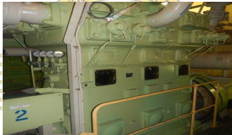
Gambar 2.6 Cargo compressor pada kapal LPG/C Mariner Sumber: Dokumen Pribadi (2021)
