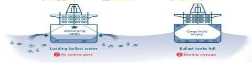
Gambar 1. Sistem ballast kapal menggunakan air laut Sumber: inameq.com 12
