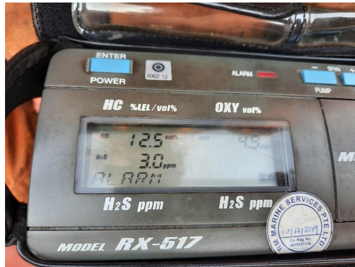
Pengecekan atmosfer tangki
