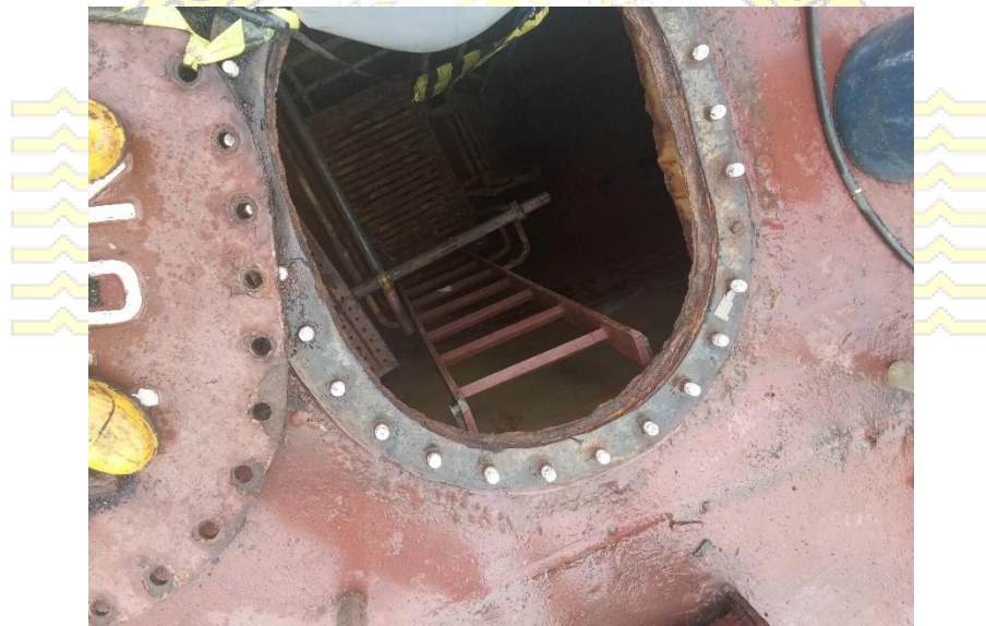
Membuka deck seal pada tangki muatan
