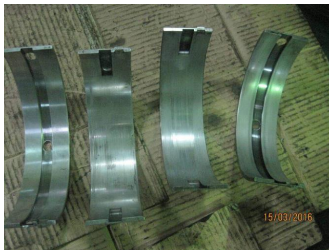
Gambar 4.7 : Keausan pada main bearing
