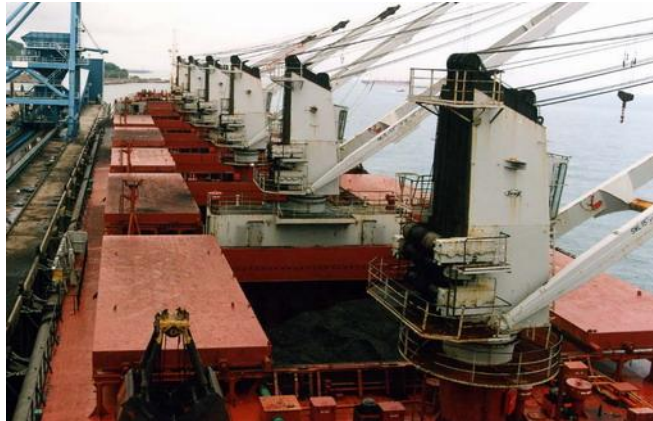
Gambar 2.9 Penutup palka jenis sliding
