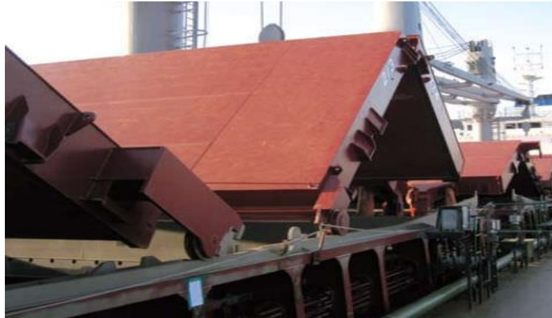
Gambar 2. 2 Penutup palka jenis folding
