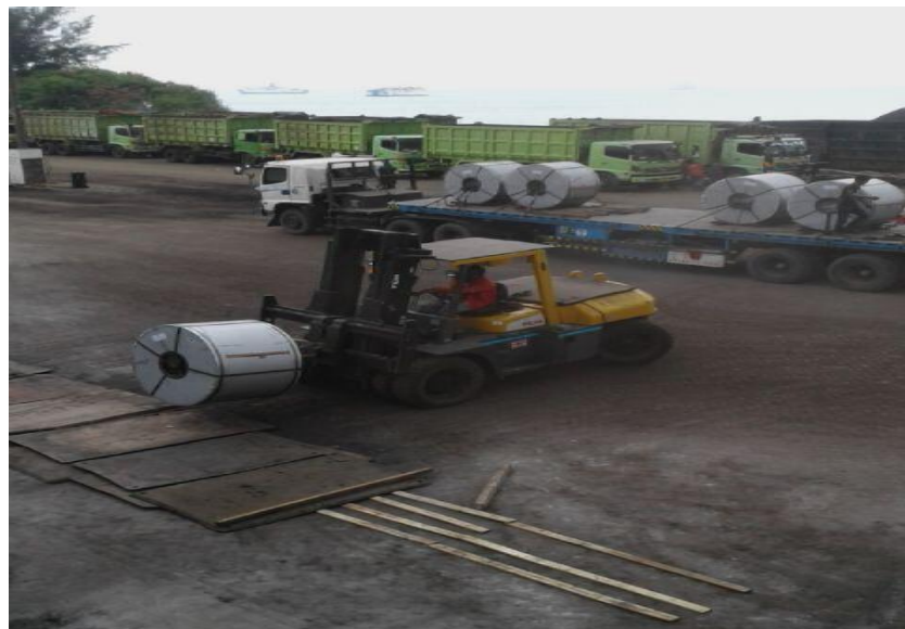
Gambar 4.3 Penggunaan forklift dalam pembongkaran coil
