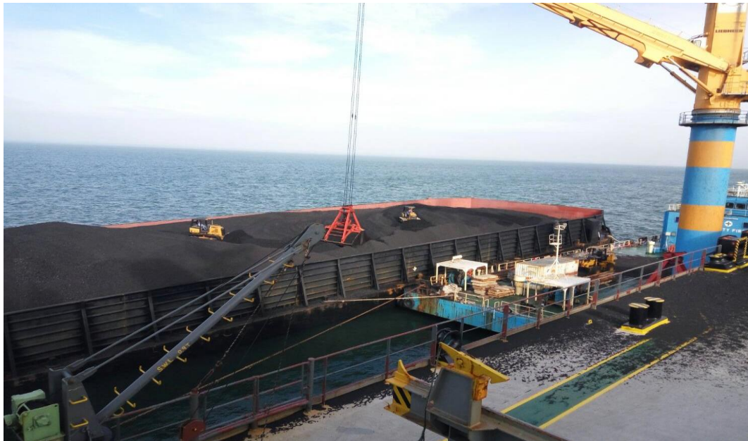
Proses memuat menggunakan floating crane .
