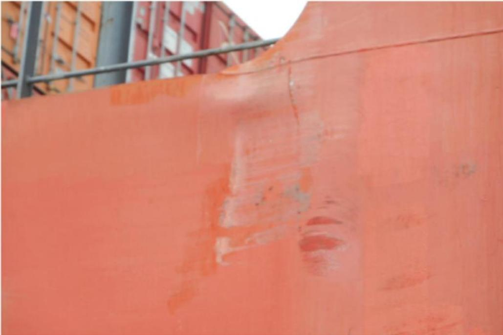
Gambar 4 & 5. Gambar lambung kapal yang tergores karena gesekan dengan dinding kolam dam di terusan panama
