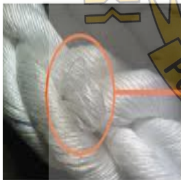
Serat tali yang rusak karena penanganan yang tidak benar
