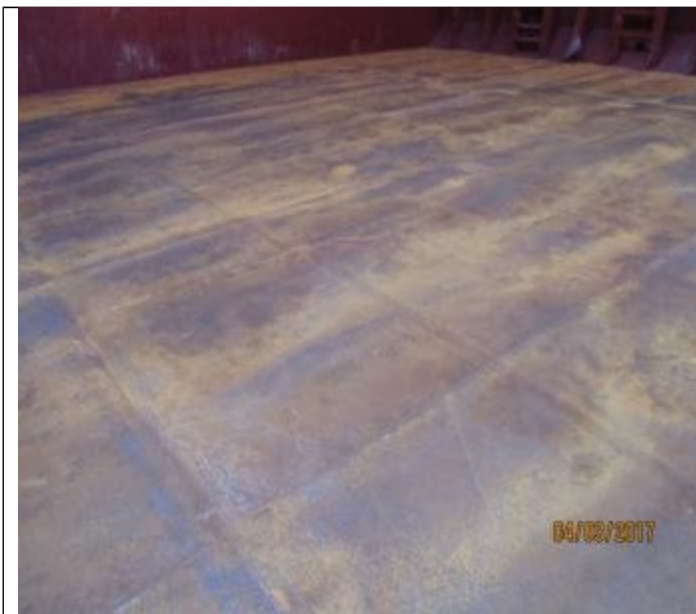
NO.2 HOLD TANK TOP PLATE 각 SIDE 에서 약 2-3 미터부근에 얇은 녹이 약간 있음
