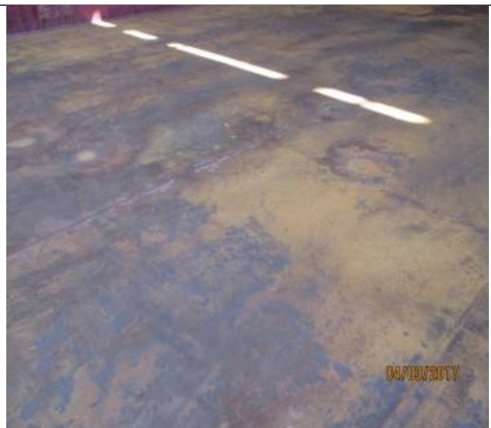
NO.2 HOLD TANK TOP PLATE 각 SIDE 에서 약 2-3 미터부근에 얇은 녹이 약간 있음
