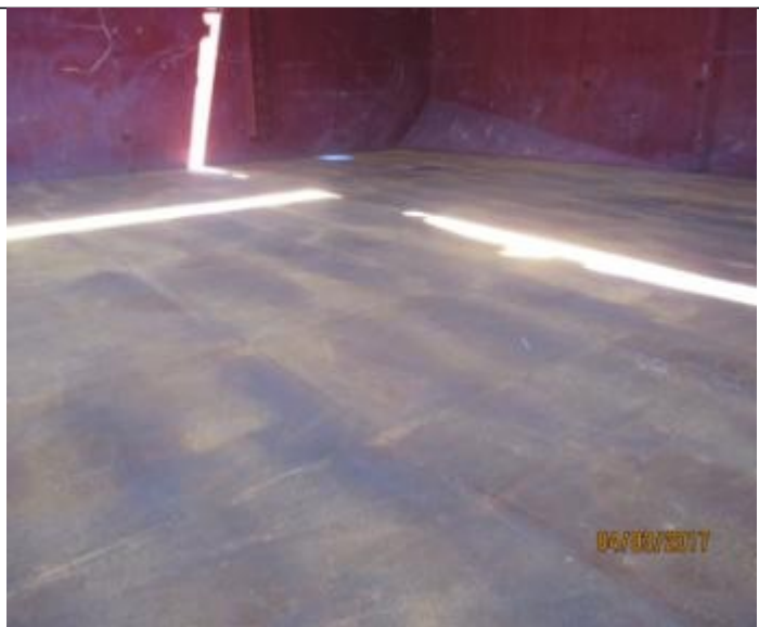
NO.4 HOLD TANK TOP PLATE 각 SIDE 에서 약 2-3 미터부근에 얇은 녹이 약간 있음
